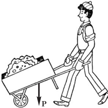
Рис. 139. Тачка как рычаг
