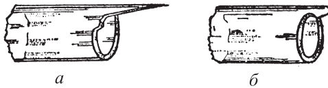
Рис. 400. а) На стеклянной трубке при разламывании образовался острый зубец. б) Тот же зубец после оплавления трубки в пламени
