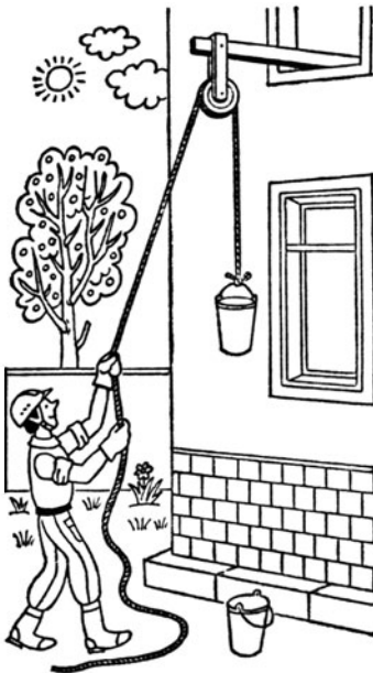
Рис. 141. Применение простого блока для подъема груза
