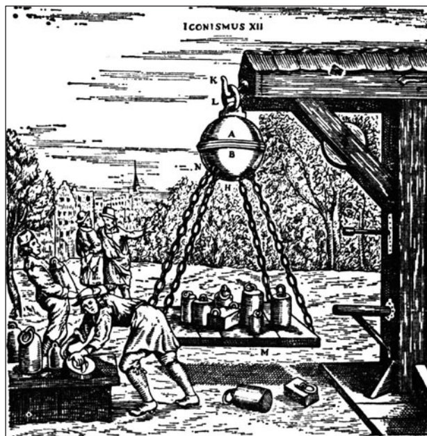
Рис. 278. Гравюра из книги Герике «Новые магдебургские опыты». Разрывание полушарий подвешенным грузом
