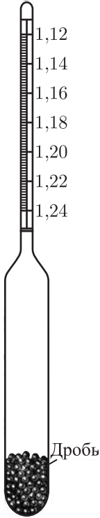
Рис. 266. Ареометр (шкала в 10^3 \text{ кг/м}^3 )
