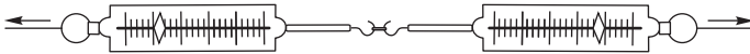
Рис. 68. Сила, с которой первый динамометр действует на второй, равна по модулю силе, с которой второй динамометр действует на первый
