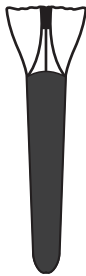
Рис. 362. Резервуар медицинского термометра, наполненный ртутью, при комнатной температуре; стеклянный волосок удерживает в трубке столбик ртути, не пропуская ее в резервуар
