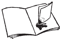
Рис. 424. Чернила, впитываясь в промокательную бумагу, поднимаются вверх
